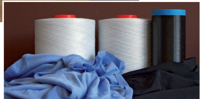
(Sotto) Filati Resistex®Carbon antistatici (Below) Resistex®Carbon antistatic yarns
